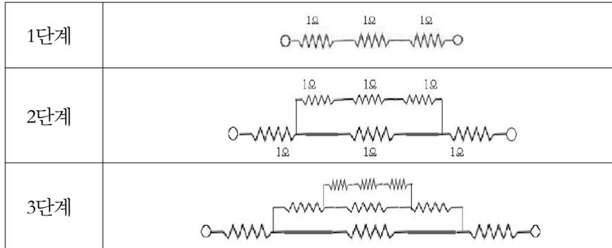
즉, 1단계의 합성저항은  $1\Omega$ 의 저항 3개를 직렬로 연결한 것이므로  $3\Omega$ 이고, 2단계의 합성저항은 가운데 병렬로  $3\Omega$ 와  $1\Omega$ 로 연결되어 있어 나머지 2개의  $1\Omega$ 짜리 저항이 직렬로 연결되어 있으므로
